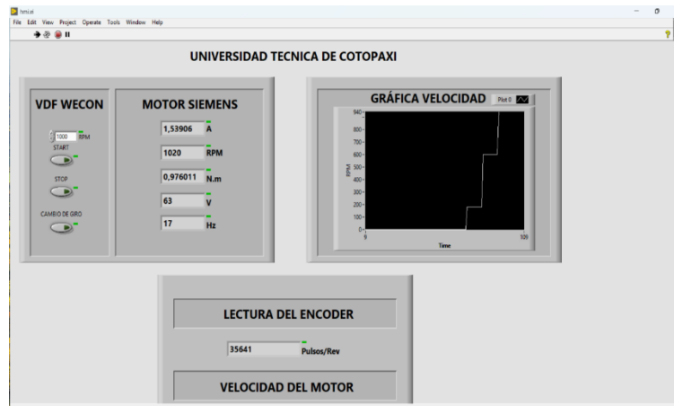
Figura 5. 8. Interfaz HMI desarrollada en LabVIEW mediante protocolo Wireless-HART
