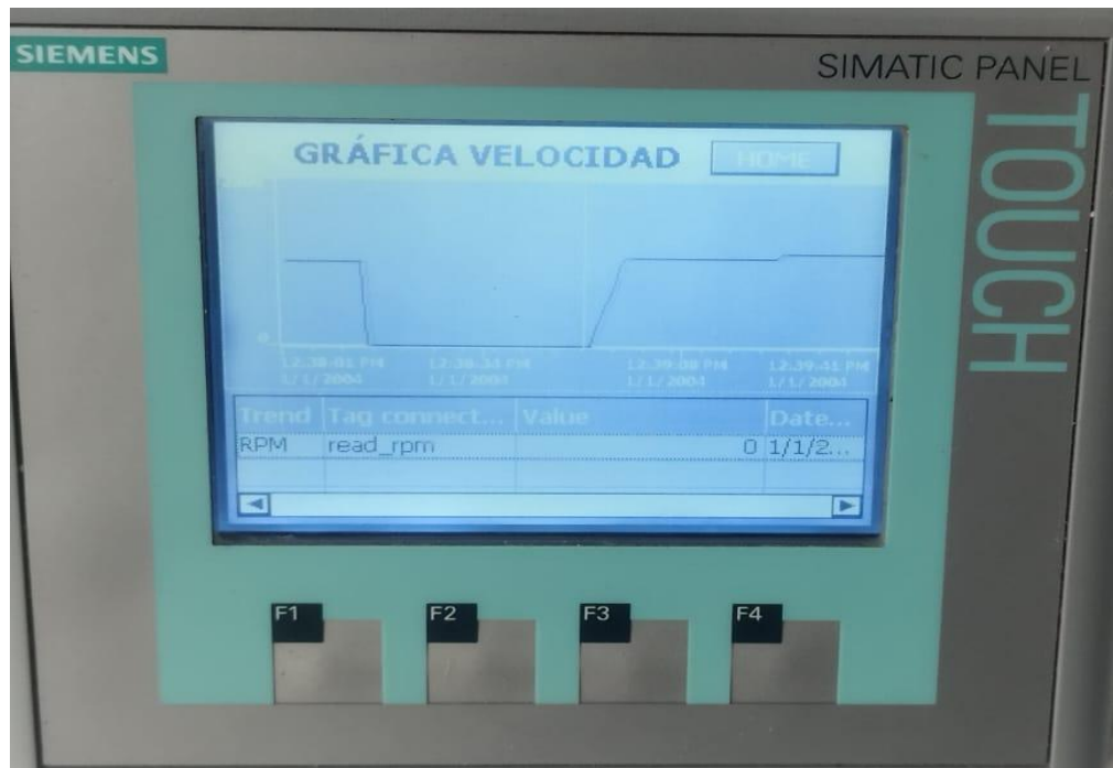
Figura 9. 4. Pantalla gráfica de velocidad del motor en función del tiempo.
