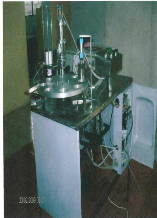
ANEXO 13-14: Envasadora terminada. Fuente: Realizada por el investigador
