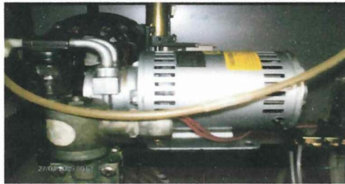
FÍGURA.Nº 43: Bomba de vacío. Fuente: Realizada por el investigador
