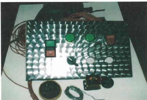
Anexo 5-6: Instalación del tablero de mando eléctrico. Fuente: Realizada por el investigador.
