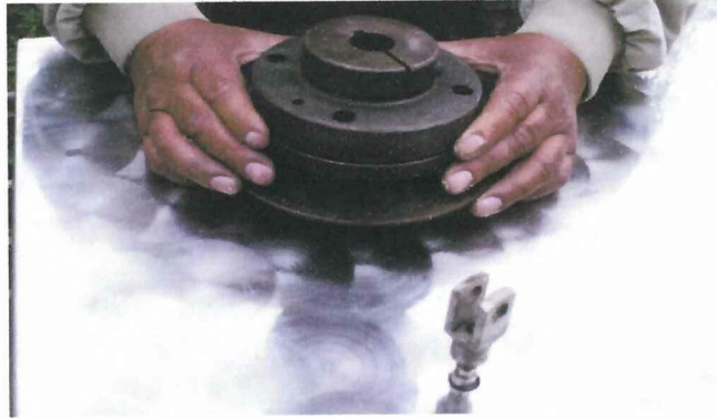
FÍGURA.Nº 27: Sujeción de Acople con eje del Reductor. Fuente: Realizada por el investigador
