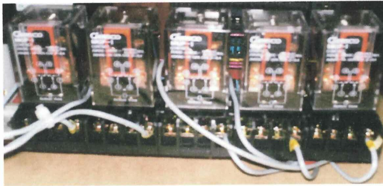
FÍGURA.Nº 38: Relé de 8 pines. Fuente: Realizada por el investigador
