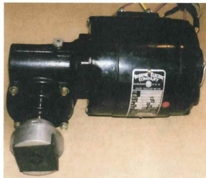
FÍGURA.Nº 36: Moto-reductor. Fuente: Realizada por el investigador
