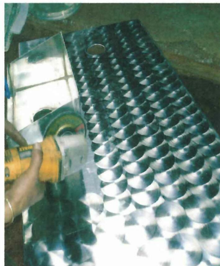
Anexo 9-10: Suelda y pulido de parte superior de masa. Fuente: Realizada por el investigador.
