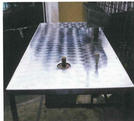
FÍGURA.Nº 26: Armado de la plancha de Ac. Inox. a la estructura soporte. Fuente: Realizada por el investigador
