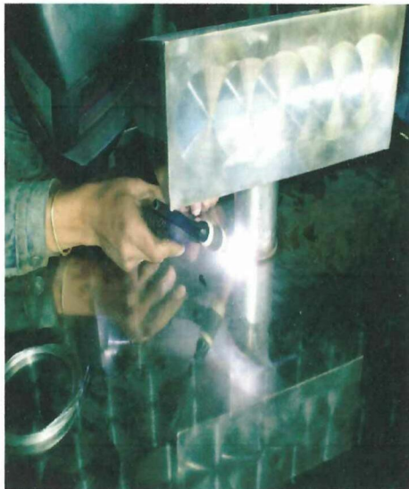
Anexo 9-10: Suelda y pulido de parte superior de masa. Fuente: Realizada por el investigador.
