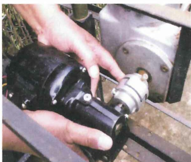
FÍGURA.Nº 24: Acoplamiento de un moto-reductor. Fuente: Realizada por el investigador
