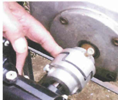
FÍGURA.Nº 24: Acoplamiento de un moto-reductor. Fuente: Realizada por el investigador
