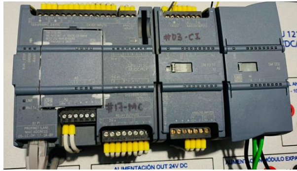
Figura 4.7 PLC S7-1200 con módulos expansión de salidas y entradas analógicas (SM 1232 6ES7232-4HD32-0XB; SM 1231 6ES7231-4HD30-0XB)
