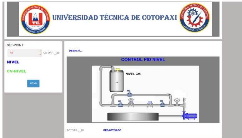
Figura 4.68 Interfaz Control PID nivel
