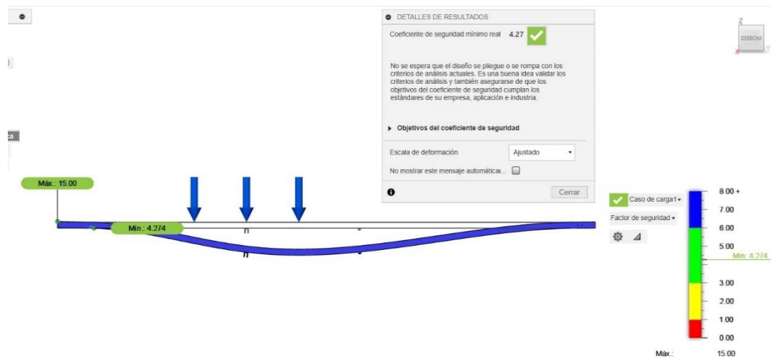
Figura 5.8. Factor de Seguridad del soporte horizontal cuadrado.
