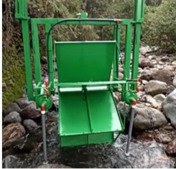
Figura 5.6, Bombas de diafragma y accesorio ensamblados en la rueda hidráulica.
