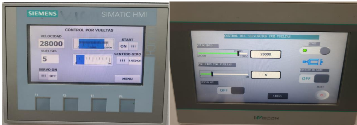
Figura 5.3 Velocidad del servomotor 20000 pps.
