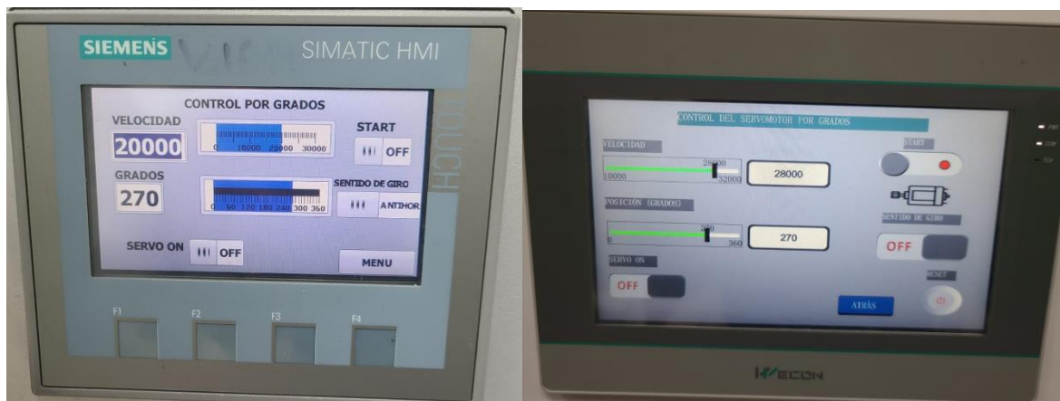
Figura 5.2 velocidad del servomotor 28000 pps
