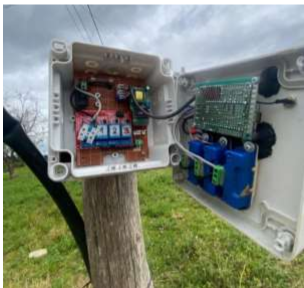
Figura 26. Implementación del módulo LoRaWAN para el perifoneo de placas
