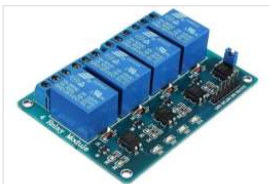
Figura 8. Relés de Control
