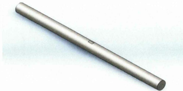
Figura 3.40: Simulación del Eje Motriz elemento del Transferidor de mesa
