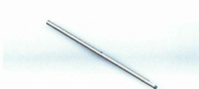
Figura 3.29: Eje motriz elemento de descarga del P.T.
