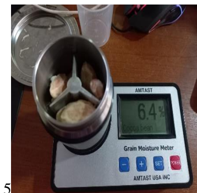
Figura 6.12 Medición de humedad residual.
