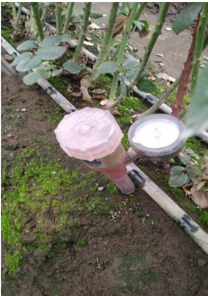
Figura 54. Humedad del suelo por el manómetro
