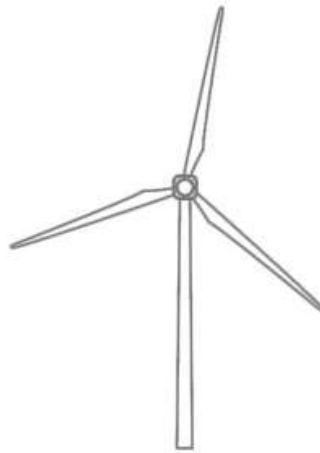
Figura 3-7: Generador eólico de eje horizontal
