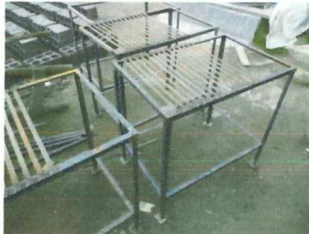
Figura 3.3. Base de malla de la mesa de trabajo
