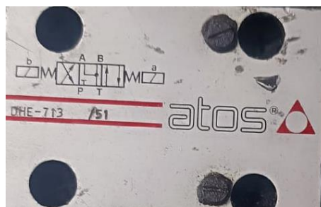
Figura 24 Esquema de Electroválvula de 3 Posiciones
