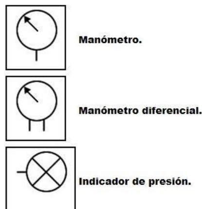
Figura 7. Simbología de manómetros hidráulicos [22]
