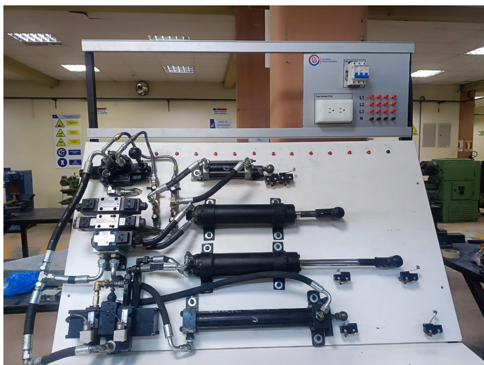
Figura 19. Ensamble hidráulico final.
