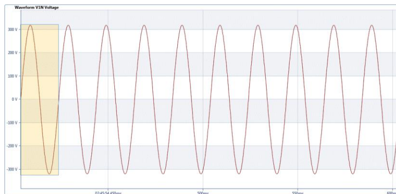
Figura 2 - Grabación de forma para registro de armónicos
