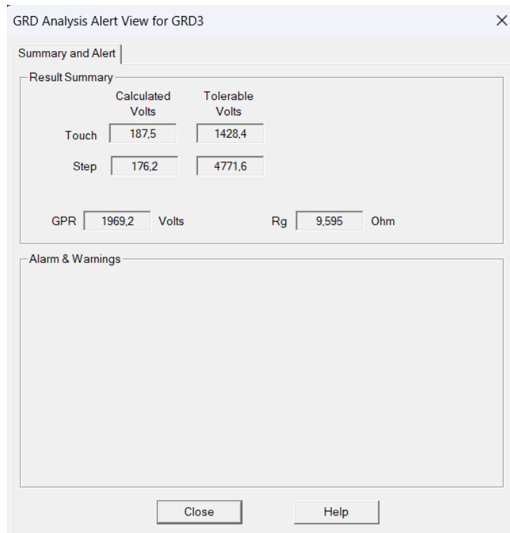
Figura 5.26 Resultados de simulación en ETAP para la validación de Rg y GPR.
