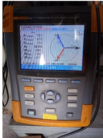
Figura 4.12 Diagrama de vectores correspondiente al analizador correctamente conectado.
