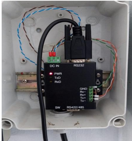
Figura 4.8 Convertidor alimentado y conectado para interfaz con el ordenador.
