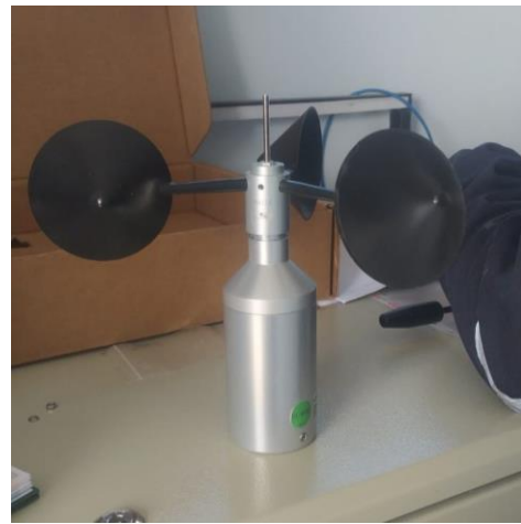
Figura 14.: Rotor DNA 124 montado sobre el sensor
