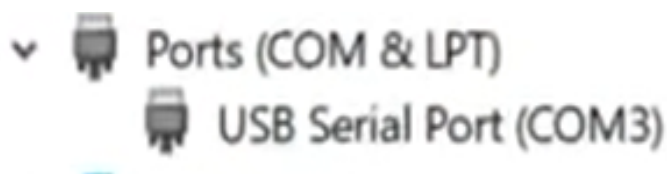
Figura 4.7: Verificación del adaptador en el ordenador (administrador de dispositivos)
