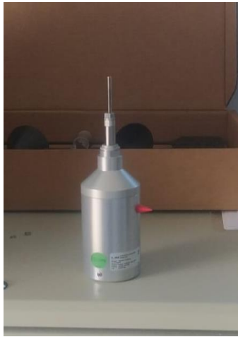
Figura 13.: Eje principal del sensor. con arandela y tuerca.
