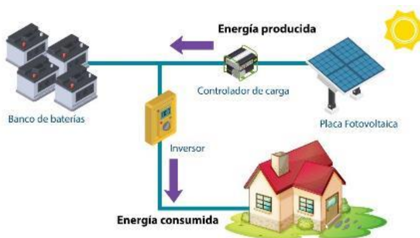
Figura 1. Funcionamiento de un Sistema fotovoltaico aislado.
