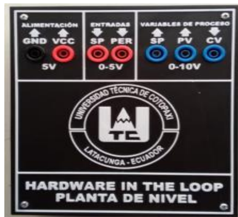
Figura 3.7. Módulo HIL para la planta de nivel.
