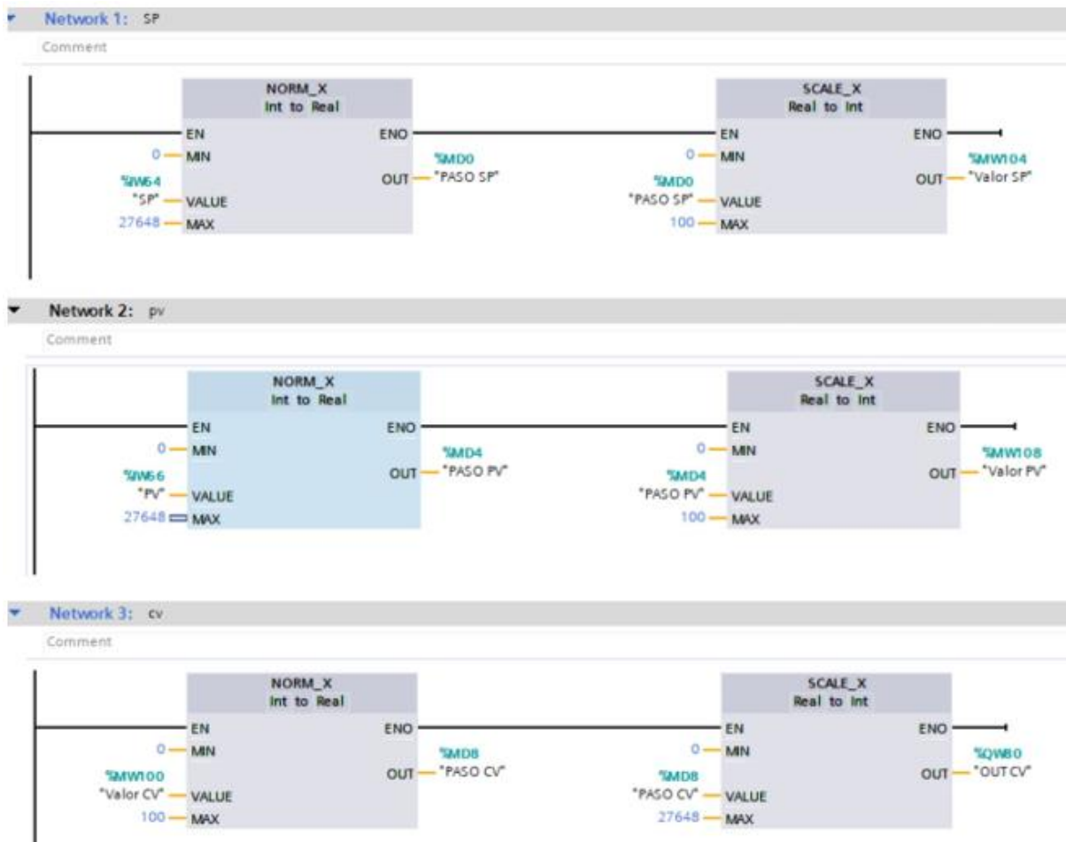
Figura 4.8. Bloques de normalización y escalado.
