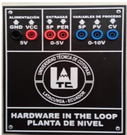
Figura 4.3. Variables de proceso del módulo HIL de la planta de nivel.
