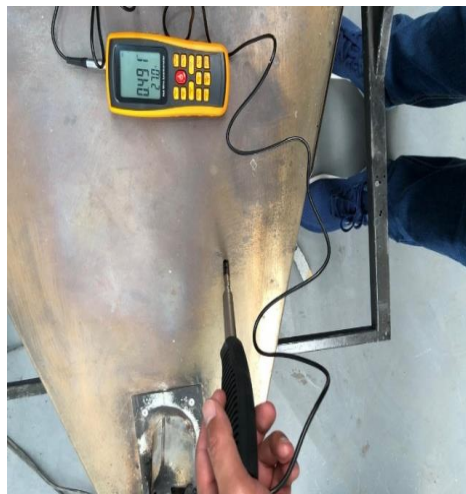
Figura 4.5. Velocidad del aire en el exterior del recubrimiento del difusor.
