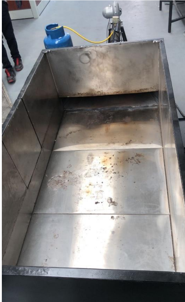
Figura 5.3. Cámara de secado sin el uso del difusor.
