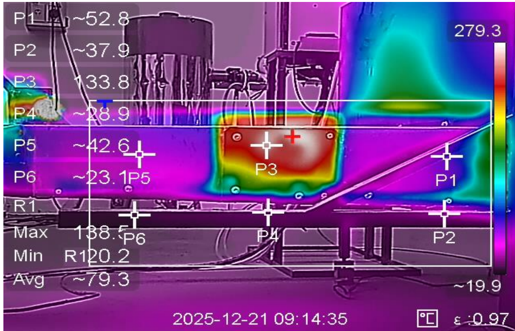
Figura 5.2. Perfil térmico del recubrimiento del difusor rectangular.
