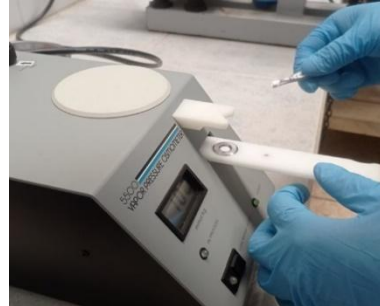
Fotografía 12 Calibración (vapor pressure osmometer 5500)
