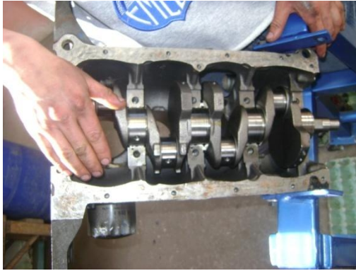
FIGURA 3.7. Armado del cigüeñal Fuente: Grupo Investigador
