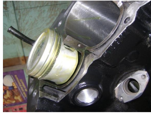
FIGURA 3.8. Introducción de pistones Fuente: Grupo Investigador
