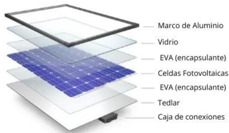
Figura 8. Partes de panel solar [28]
