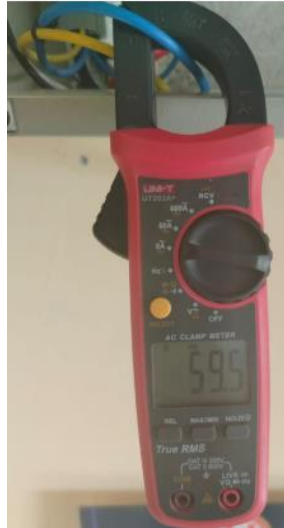
Figura 52. Frecuencia del sistema Fotovoltaico
