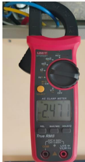
Figura 50 Medición de corriente consumida en AC
