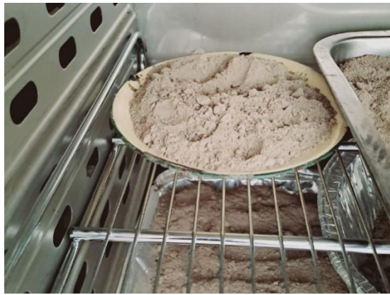
Figura 5: Calor seco controlado para eliminar la humedad de muestras de tierra.
