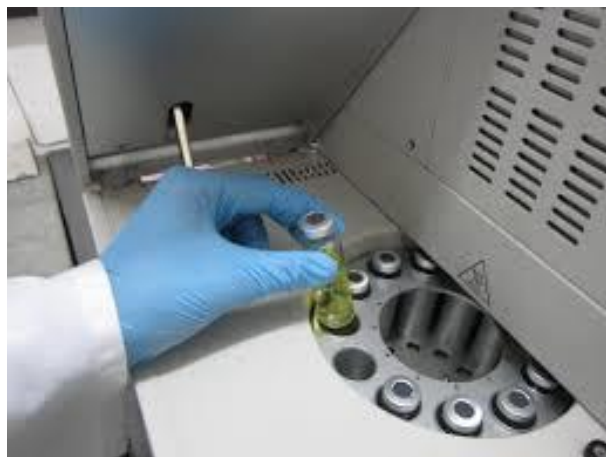
Figura 4. Prueba DGA a una muestra de aceite mineral [15].
