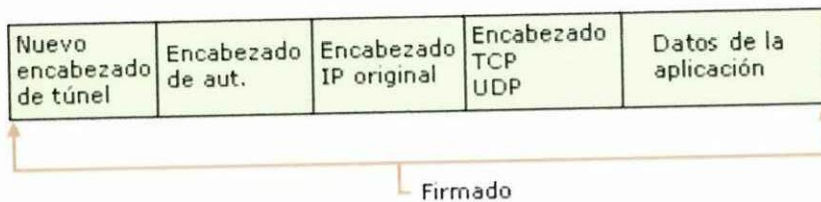
Figura 2.10: Representación de un túnel AH.
