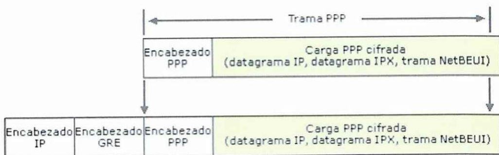
Figura 2.4: Encapsulación PPTP para una trama PPP.
