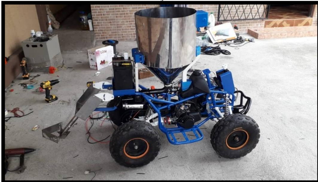
ANEXO 17 Ensamblaje del sistema mecánico
