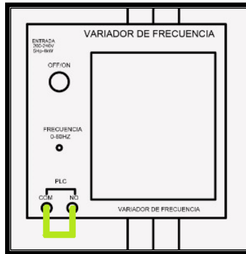
Figura 4 Conexión COM – NO
