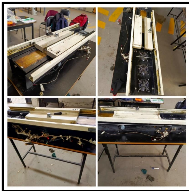
Figura 4.3. Inspección visual de la encoladora de libros
