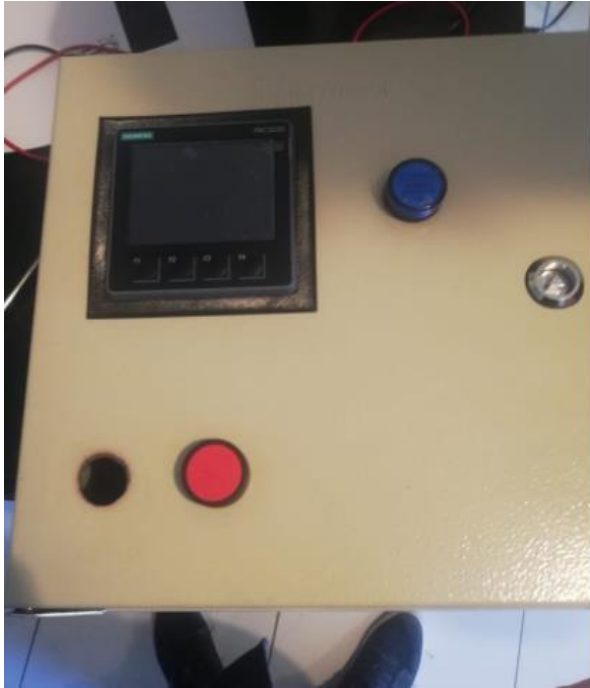
Fotografía 1. Perforaciones en el gabinete metálico para sujetar los materiales.
