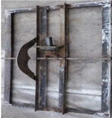
Base del panel solar FV
