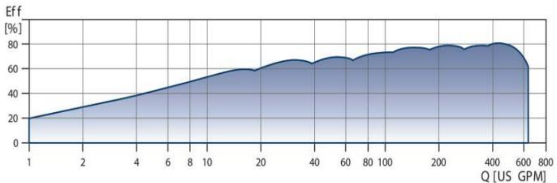
Figura 18 Curva de eficiencia técnica de la electrobomba seleccionada.
