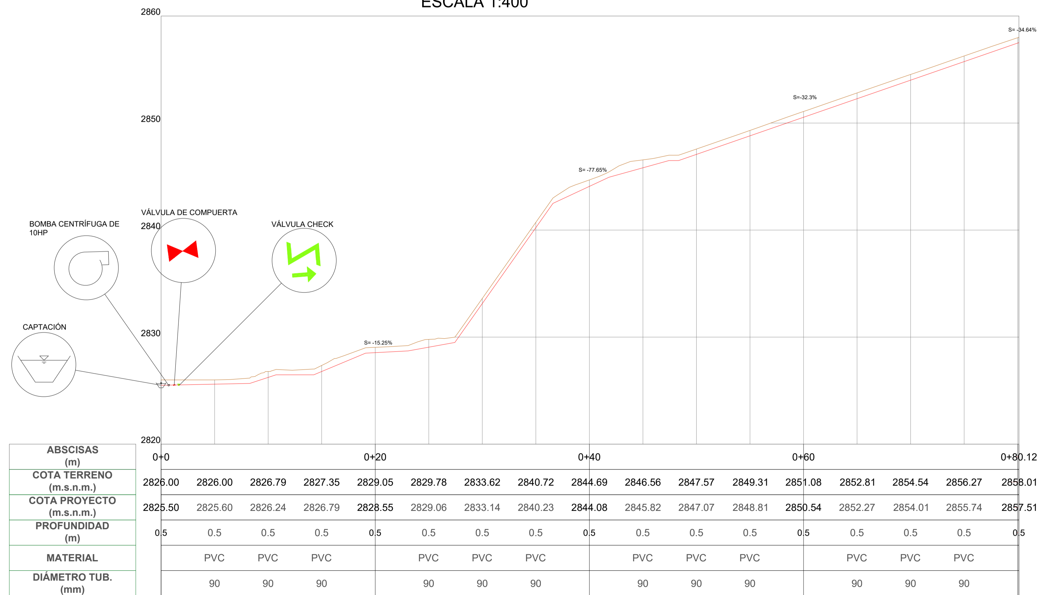
9 PERFIL LONGITUDINAL 1 CONDUCCIÓN ZONA 1
