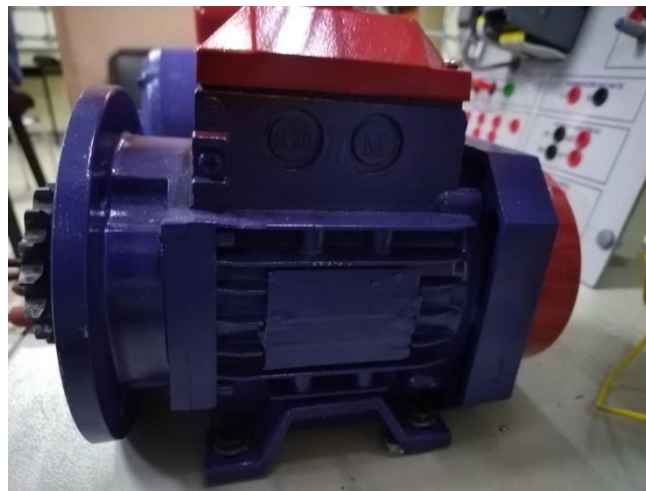
Figura. 36 Motores en simulación de bombas.
