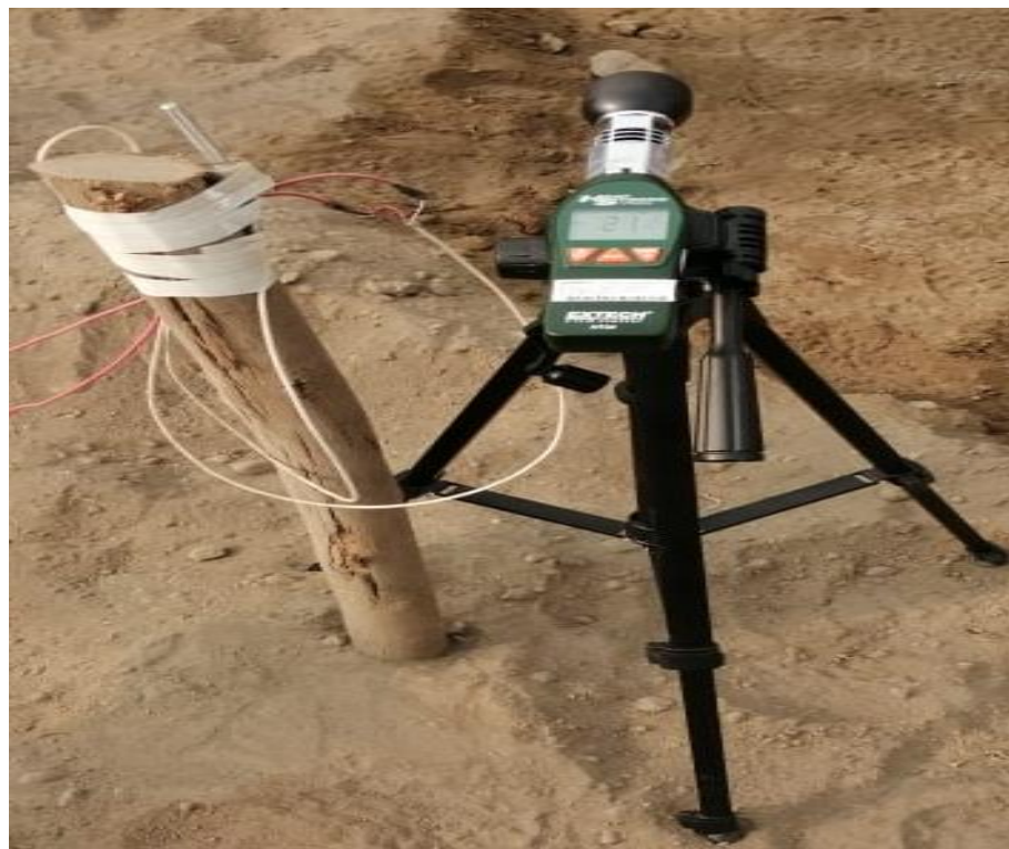
Figura A.14.3. Calibración del sensor Pt 100
