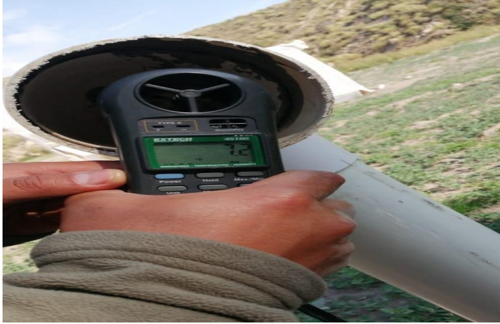
Figura A.14.5. Medición del flujo de aire que atraviesa la tubería
