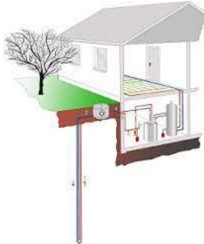
Figura 3.8.B. Captación vertical de calor [16]
