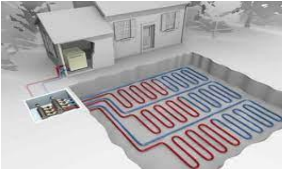
Figura 3.8.A. Captación horizontal de calor [16]
