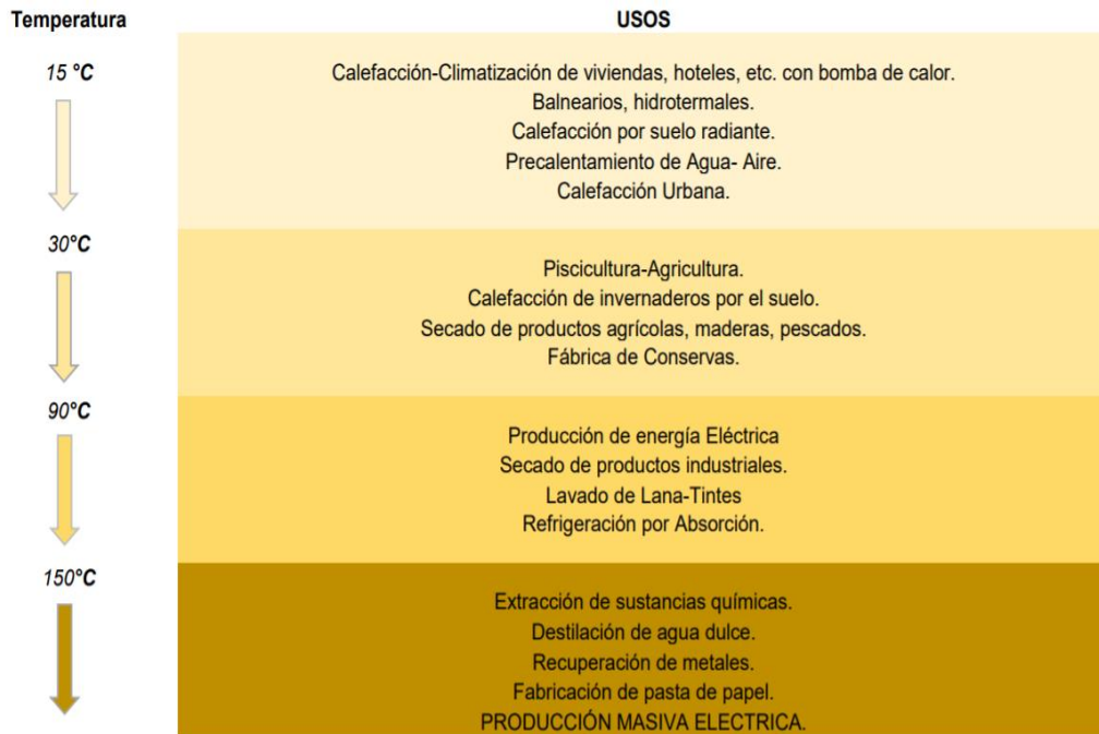
Figura 3.3.A. Temperatura según el nivel de reservorio geotérmico [10]
