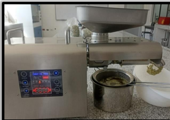
Figura 20. Extracción del aceite por la máquina extractora de aceite oleaginosas
