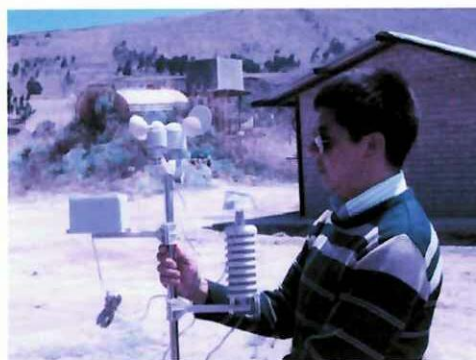
Gráfico 16. Instalación del Anemómetro
