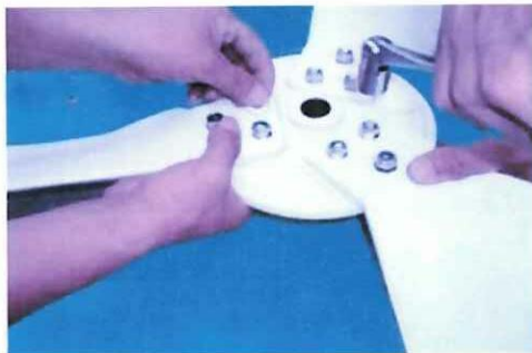
Gráfico 33. Colocación de las aspas en el equipo
