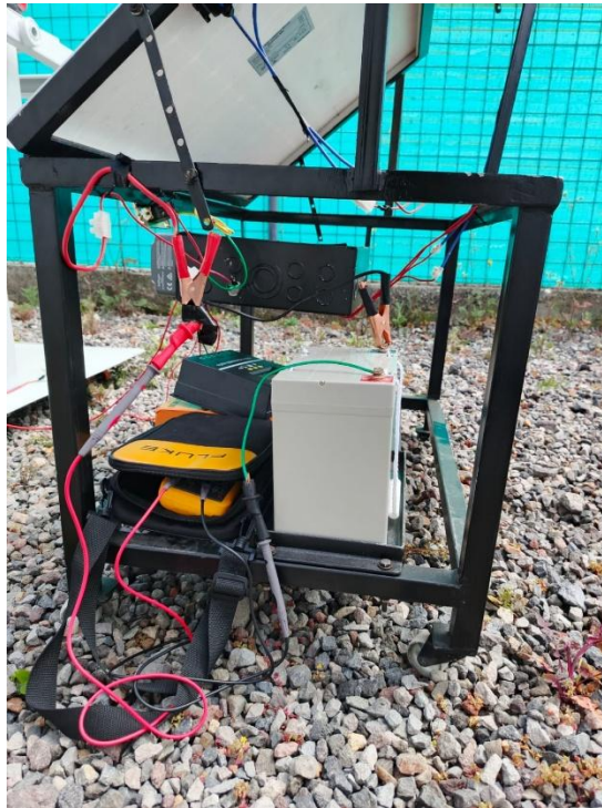
Figura 41. Conexión de la batería de ácido-plomo gel para la carga
