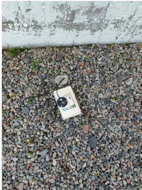
Figura 38. Obtención del recurso solar mediante el piranómetro
