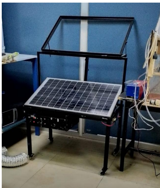
Figura 13. Estado inicial del prototipo fotovoltaico off-grid
