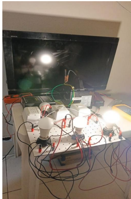
Figura 46. Descarga de la batería bajo condiciones de uso
