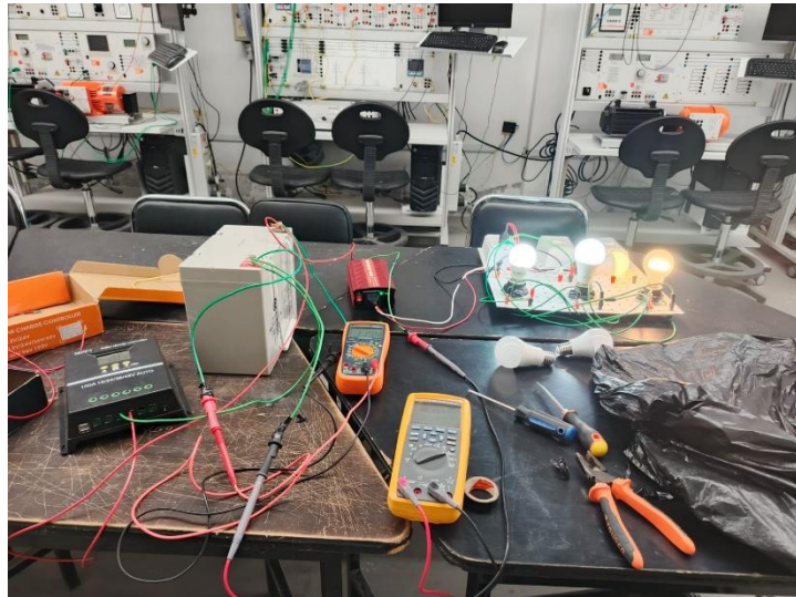
Figura 47. Descarga de la batería (C-rate)
