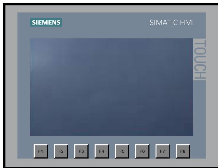
Figura 4.8. Pantalla HMI siemens Simatic ktp60
