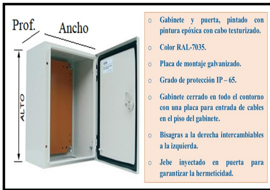
Figura 4.16. Gabinete de control eléctrico 70 x 50 x 20 IP 65
