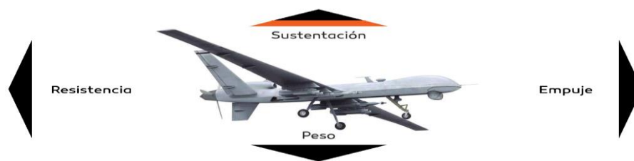
Figura 3.9 Fuerzas que interactúan en vuelo
