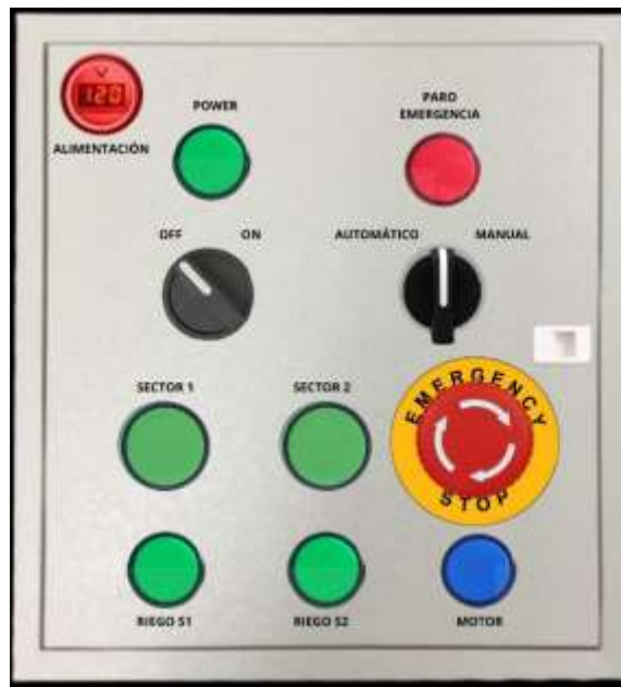
Figura 4-6: Diseño del tablero de control
