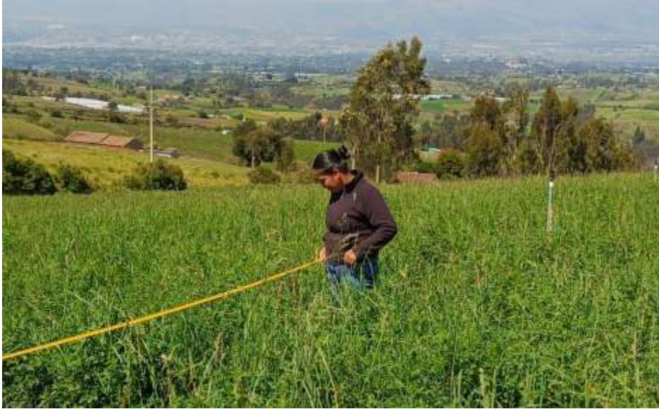
Figura 4-13: Medición de longitud de sistema hidráulico.
