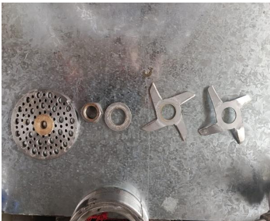
Construcción Cuchillas y Rejilla
