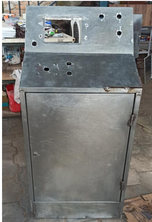
Figura E.1. Construcción del tablero de control en material de acero inoxidable.
