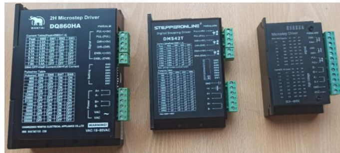
Figura 5.7. Controladores Microstep Driver.
