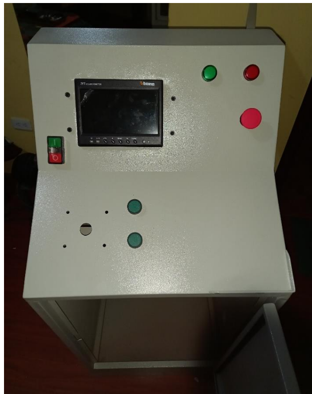
Figura E.2. Acabado del tablero de control con pintura electroestática.
