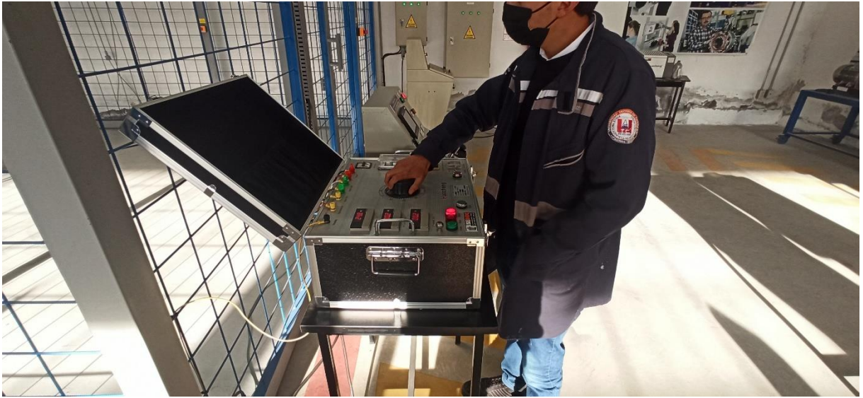
Figura F.3. Manipulación del módulo de control de transformador de Alto Voltaje para ensayos de disrupción dieléctrica.
