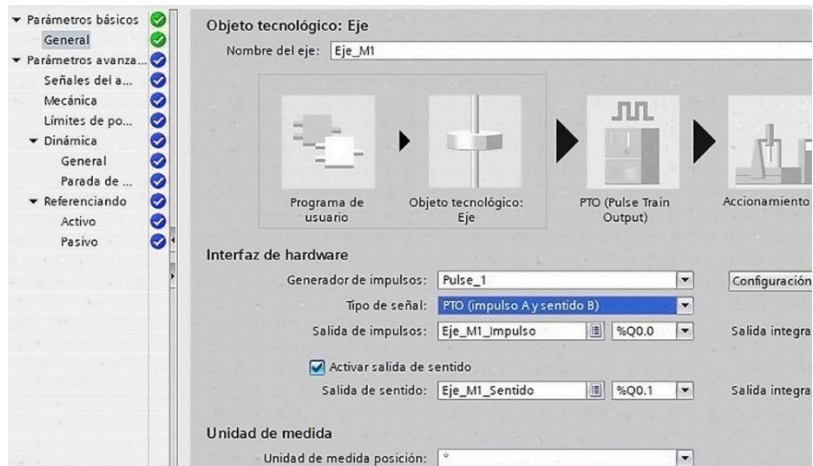
Figura D.3. Parámetros a configurar en el bloque tecnológico de control de movimiento.
