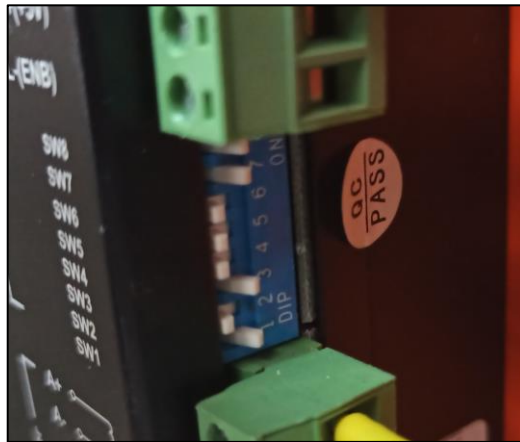
Figura 5.38. Configuración de los dip switch en el driver del motor Nema 34.
