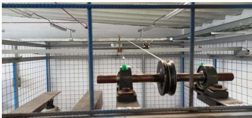
Figura 5.17. Adaptación de la estructura mecánica para el motor en el eje z.
