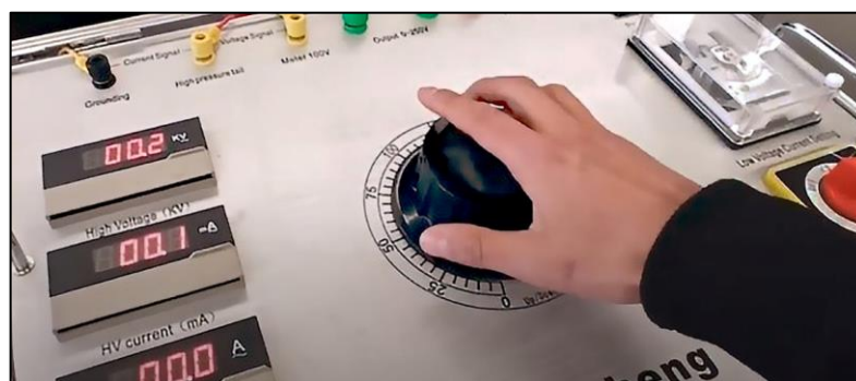
Figura 5.48. Control del nivel de voltaje en el módulo de control del transformador de Alto Voltaje.
