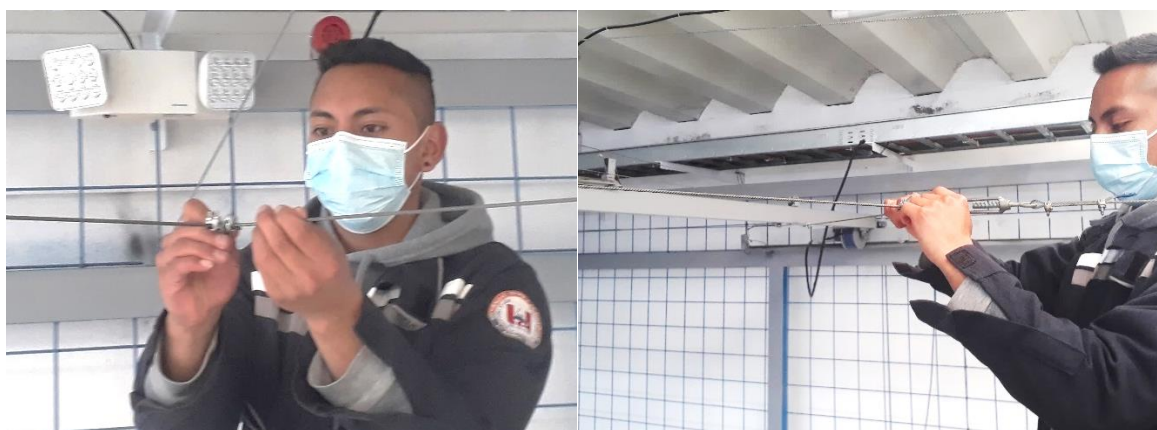
Figura 5.43. Modificación de la posición de los grilletes en el cable de acero del eje z.
