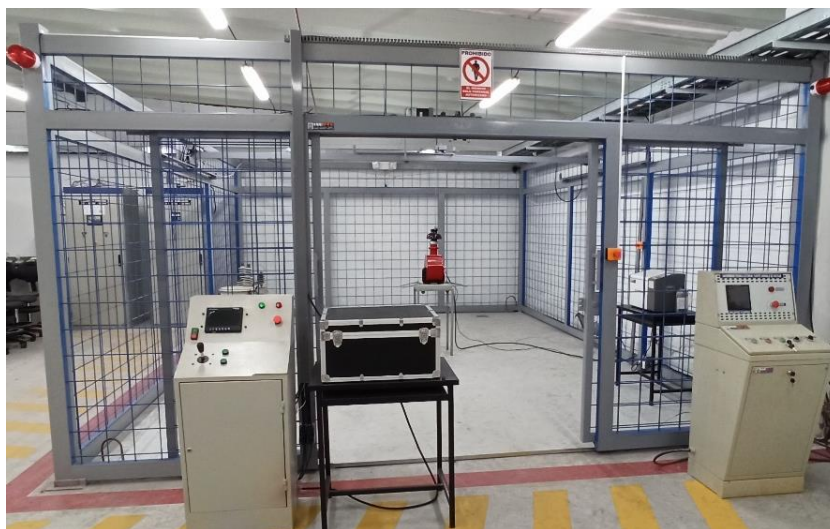
Figura 3.1. Jaula de Faraday del Laboratorio de la Universidad Técnica de Cotopaxi.
