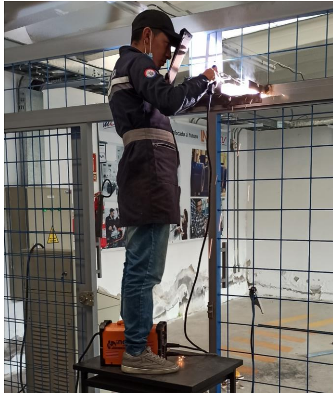
Figura A.5. Proceso de soldadura para el movimiento del eje z.
