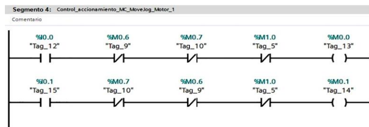
Figura 5.24. Programación en lenguaje ladder para el control de movimiento del Motor 1.
