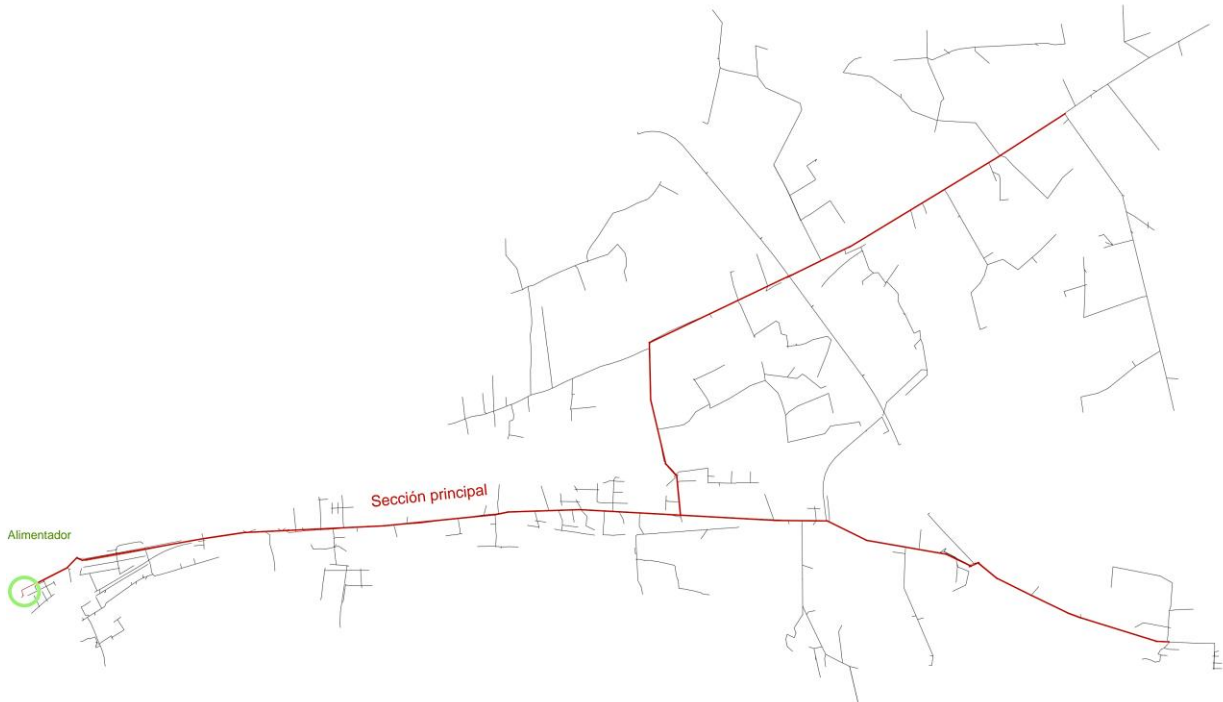
Figura 5.1 Sistema eléctrico de distribución - Brigada Patria [46].
