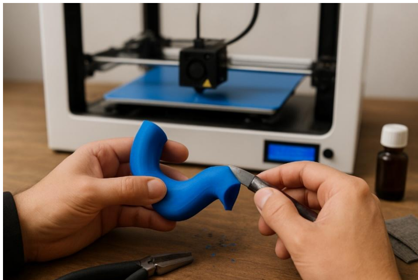
Figura 6. Proceso de post-procesamiento y acondicionamiento de un prototipo fabricado mediante impresión 3D.
