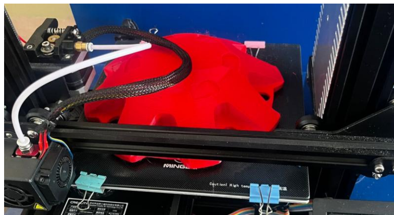
Figura 14. Prototipo de tapacubos fabricado mediante impresión 3D FDM
