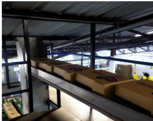
Figura 4.20: Traslado de cartón a empaque por bajante.
