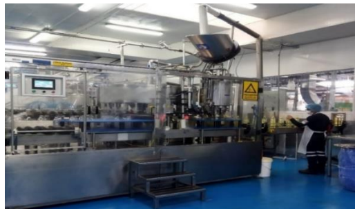
Figura 4.14: Línea de producción AUSERE para envasado de aceite en botella.
