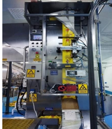
Figura 4.16: Línea de producción PREPAC para envasado de aceite en funda.
