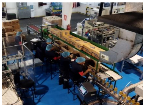
Figura 4.21: Empaquetado de botellas de aceite en cartones.
