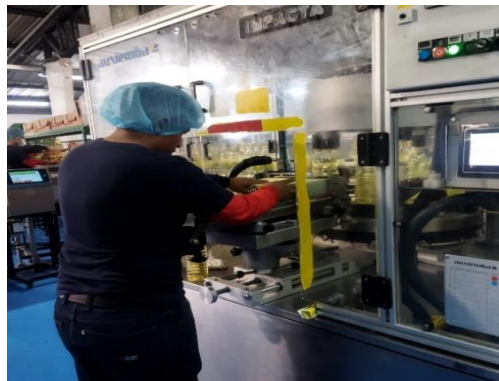
Figura 4.18: Operario colocando etiquetas en la máquina etiquetadora.
