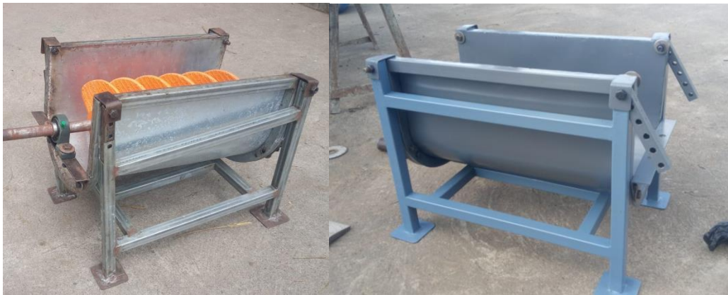
Proceso de colocación del tornillo en la base y medida de grados de inclinación
