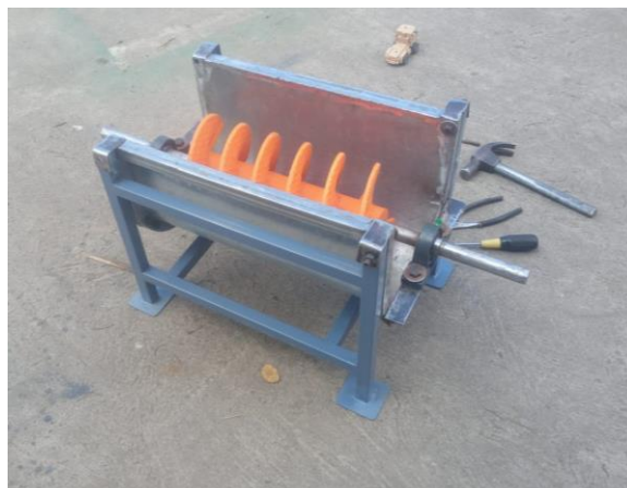
Proceso de pintado de la base y estructura
