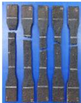
Figura 1. Condiciones finales de las probetas M1 a M5 (MS-21-0334 a MS-21-0338) después de los ensayos de resistencia a tracción tomando como referencia la norma ASTM D638-14.
