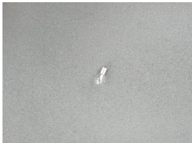
Fig. 49. Prueba de impacto de bombillo con piso flexible Fuente: El autor
