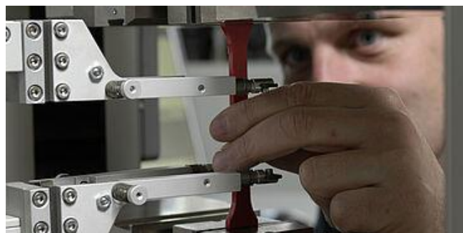
Fig. 21. Montaje de la probeta en la máquina de ensayos Fuente: [32]
