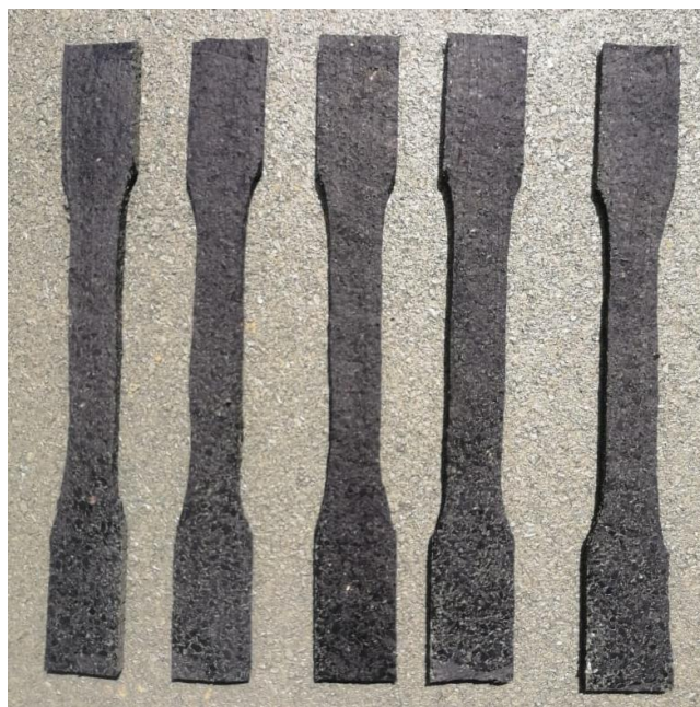
Fig. 45. Dimensiones para la probeta de ensayos de tracción
