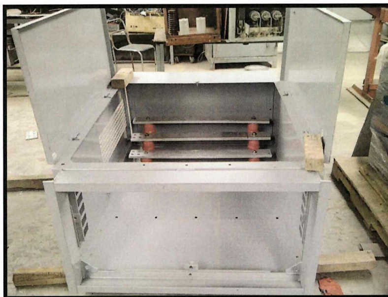
Figura No. 2.6 Tablero de Distribución
