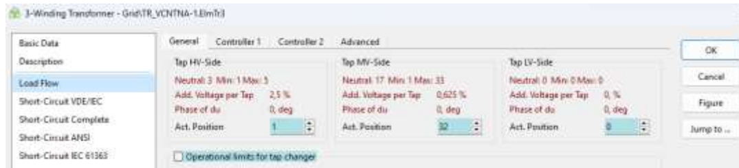
Figura 15: Verificación del tap del TR_VCNTNA-1 en Power Factory
