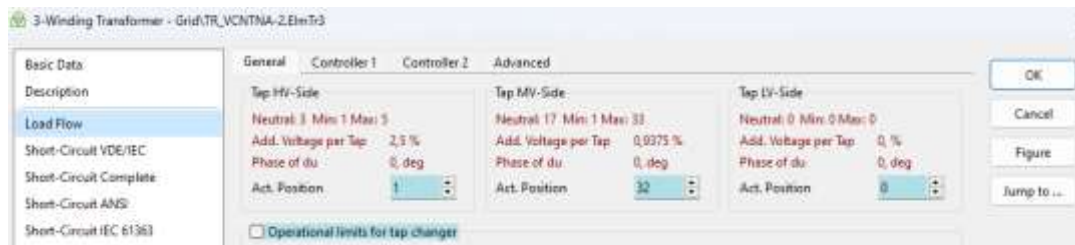
Figura 16: Verificación del tap del TR_VCNTNA-2 en Power Factory
