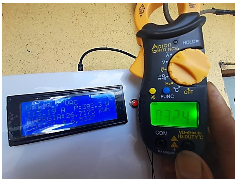
Figura 5. 4. Mediciones realizadas por la pinza amperimétrica y el prototipo implementado.
