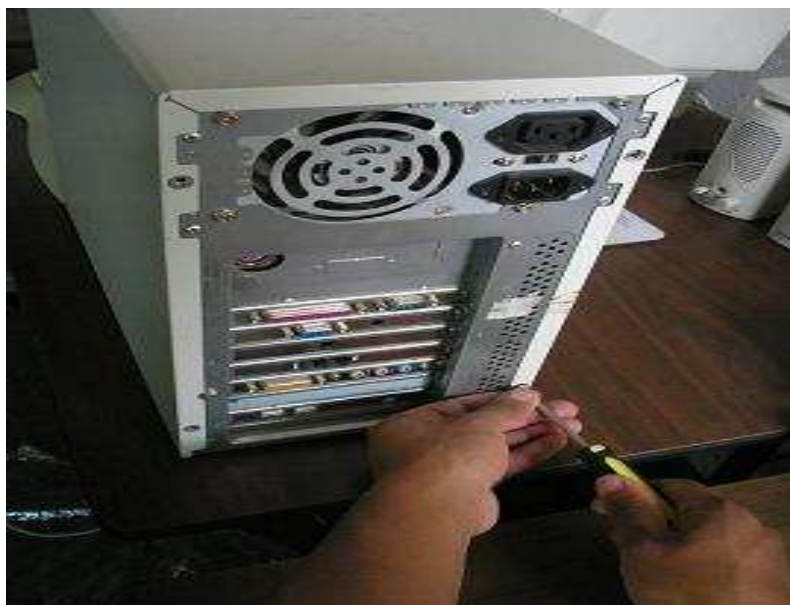
Gráfico 36. Destapar la cubierta del PC
