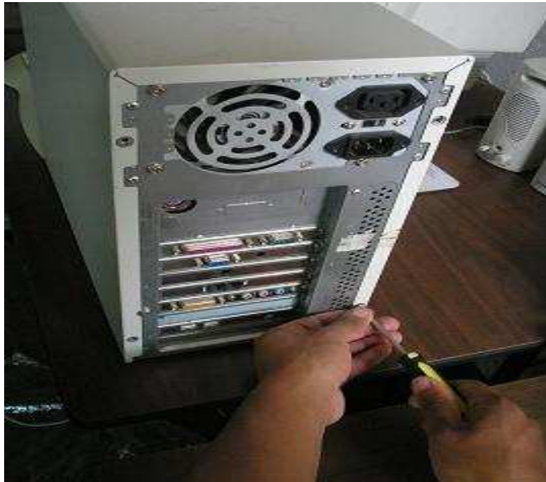
Gráfico 43. Tapan el case del PC
