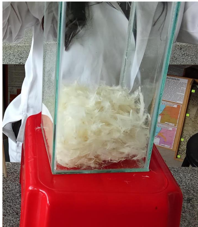
Figura 5. Diseño de filtro de vidrio con lecho filtrante de plumas de gallina.
